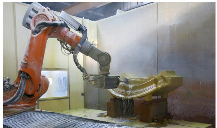
Der Roboter fräst die Verdachung des Bukranionfensters.
