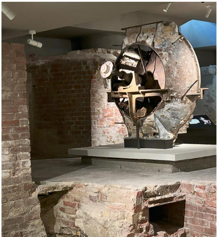
**Eine der beiden elektrisch angetriebenen Turbinen aus dem Jahr 1900, mit der die Warmluft von der Heizung in den Weißen Saal befördert wurde.**
