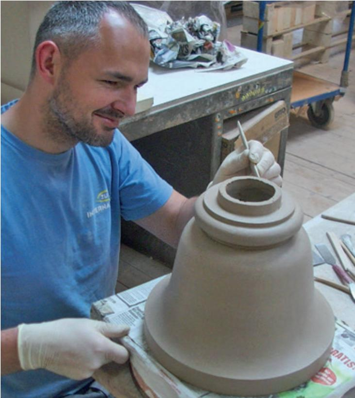
Herstellung der Form zur Vervielfältigung dieser Balusterbasis für den Kuppelumfang
