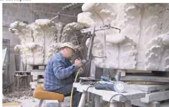
Mit dem Punktiergerät werden die Maße des Gipsmodell auf den Sandsteinblock übertragen (oben)
