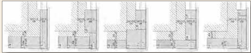
Aufmaße von Fenstergewänden mit widersprüchlichen Formen und Maßen von unterschiedlichen Fenstern desselben Typs aus dem Schlüterhof.
