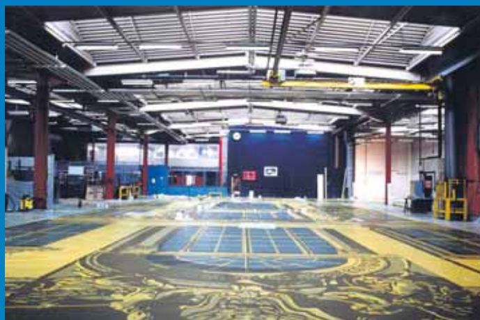
Die Foliensfassade entsteht in Handarbeit in Paris in einem ehemaligen Automobilwerk, April 1993
