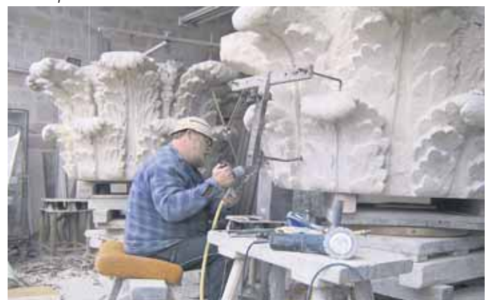
Mit dem Punktiergerät werden die Maße des Gipsmodell auf den Sandsteinblock übertragen (oben)
