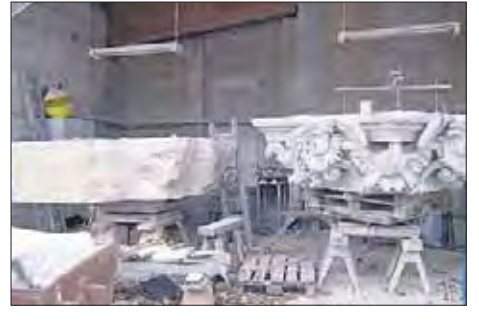
Sächsische Sandsteinwerke Pirna bei Dresden. Der Prototyp des Kolossalkapitells der Portale I und II wird nach dem Gipsmodell jetzt in Sandstein geschlagen.
