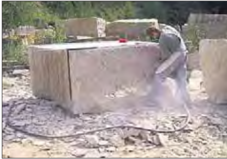
Sächsische Sandsteinwerke Pirna bei Dresden. Der Prototyp des Kolossalkapitells der Portale I und II wird nach dem Gipsmodell jetzt in Sandstein geschlagen.
