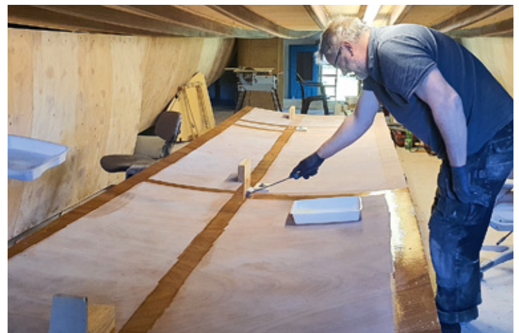
Die vorgewölbte Bordwand aus wasserfestem Bootsbausperrholz wird mit Kunstharz versiegelt.
