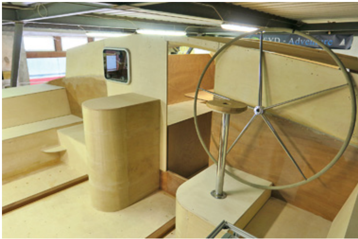
Die Kajüte und das Cockpit des Katamarans mit dem Fußboden und den Zargen für die Persenning aus alten Fundamentpfählen des Schlosses. Sogar ein kleines Messingschild mit dem Schlosshinweis ist an altem Schlossholz in der Kajüte angebracht!
