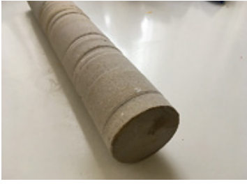
Einer der Bohrkern der Hermenpilaster
