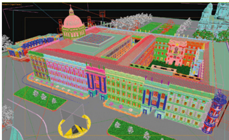
Blick hinter die Kulissen: Drahtgitterkonstruktion des Schlosses im Computer, Datenmenge rund 8 Terrabytes, es fehlen auf diesen Bildern die Textur und die farbige Fassadenoberfläche.
